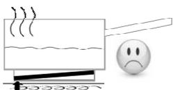
Ferromagnetisches Element wurde schlecht eingebaut
